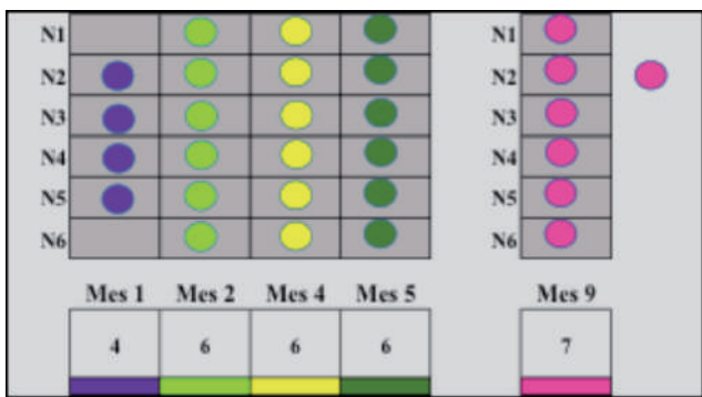
Figura 4. Esquema de extracción de la puesta en vía con tráfico
