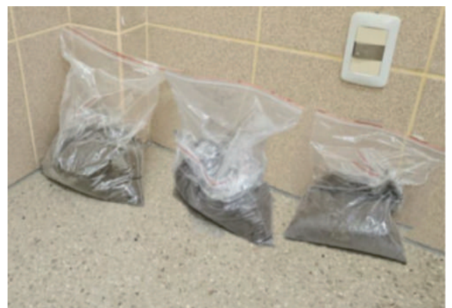
Figura N°6: Conservación de las arenas para garantizar el contenido de humedad Fuente: Elaboración propia
