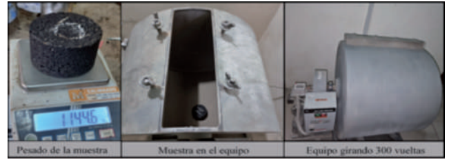
Figura 18. Imagen de ensayo de cántabro en la máquina de Los Ángeles
