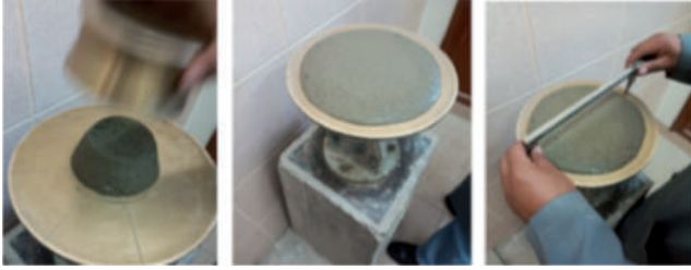
Figura N°7: Determinación de la fluidez del mortero Fuente: Elaboración propia
