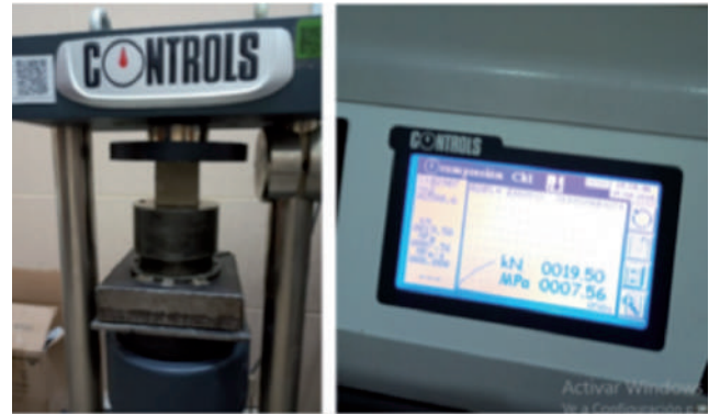
Figura N°11: Ensayo de compresión de probetas Fuente: Elaboración propia
