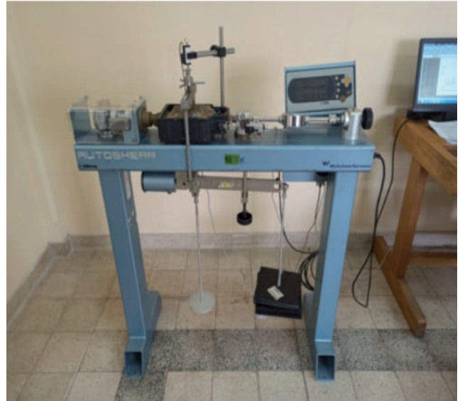
Figura 3.1 Equipo automatizado de corte directo Wykeham Farrance AutoShear Mod.27-WF2160 del Instituto de Ensayo de Materiales de la UMSA
