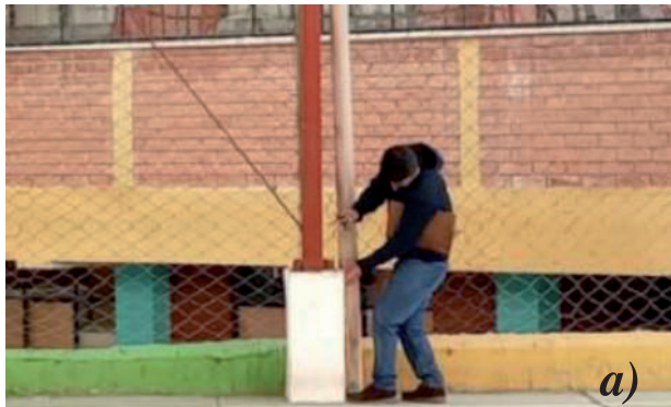
Figura 2. Toma de datos de las a) geometría y b) lesiones en los pedestales de hormigón armado Fuente: Elaboración propia.
