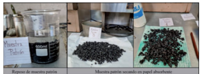
Figura 14. Imagen de ensayo de adherencia de la mezcla
