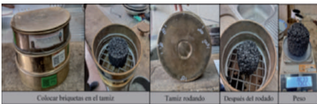
Figura 17. Imagen de ensayo de Cohesión
