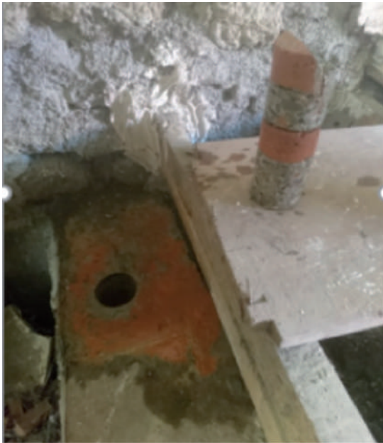
Figura 8. Extracción de núcleos
