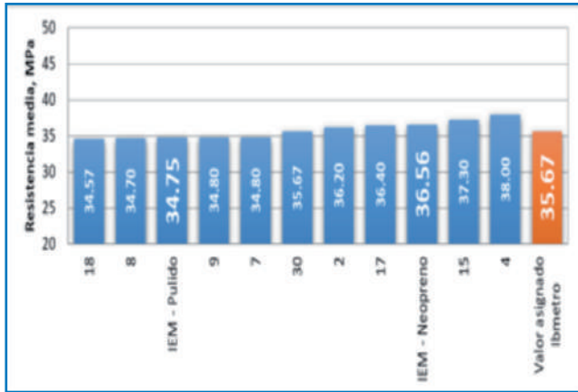
Figura 2. Resultado de la participación en ensayos de aptitud 2018 - H21, del área de Hormigones. (Fuente: Área de Hormigones)
