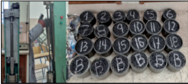
Figura 8. Fabricación de briquetas en laboratorio IEM-UMSA
