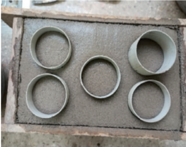
Figura N°13: elaboración de probetas para ensayo de adherencia Fuente: Elaboración propia
