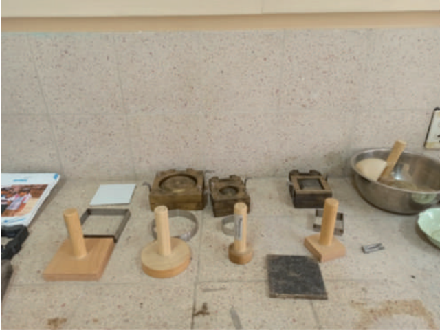
Figura 2. Cajas de corte de forma circular y cuadrada de diferente tamaño del equipo automatizado de corte directo Wykeham Farrance AutoShear Mod.27-WF2160
