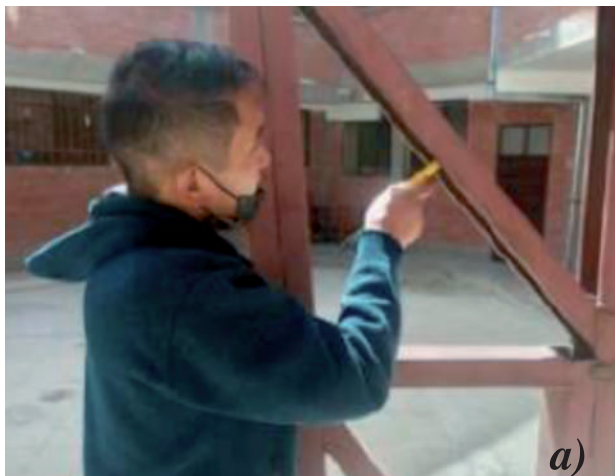
Figura 3. Toma de datos de las a) geometría y b) lesiones de los perfiles conformados en frío Fuente: Elaboración propia.
