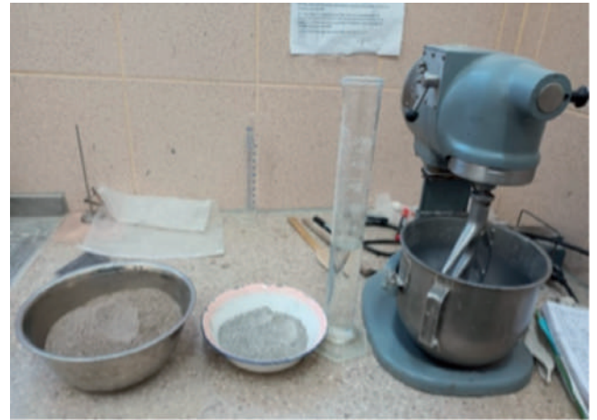
Figura N°5: Preparación para el amasado del mortero Fuente: Elaboración propia
