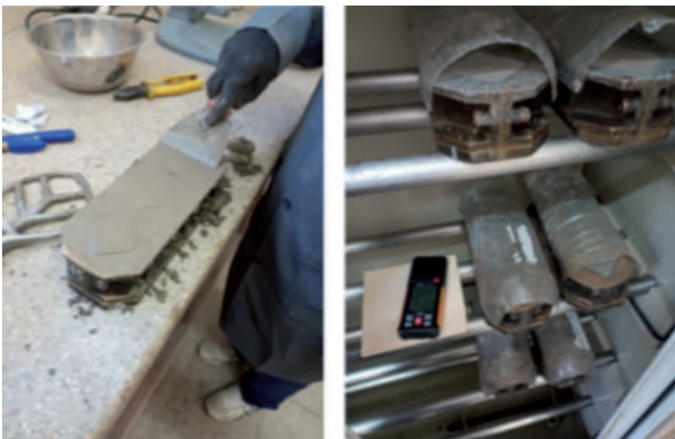
Figura N°9: Enrasado y curado de probetas Fuente: Elaboración propia
