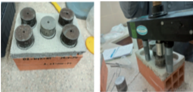
Figura N°14: Ensayo de adherencia Fuente: Elaboración propia
