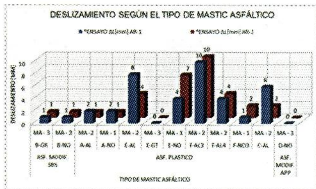
Figura N°10 Deslizamiento según el tipo de mástico Asfáltico
