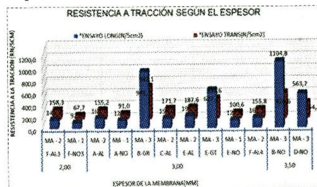
Figura N° 8 Resistencia a Tracción según el Espesor de la Membrana.
