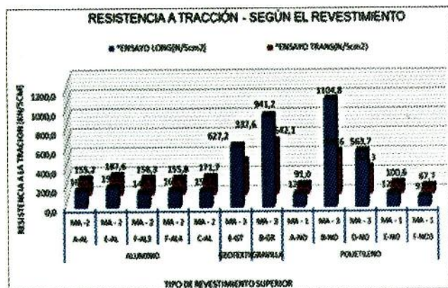
Figura N° 5 Resistencia a Tracción según el Revestimiento
